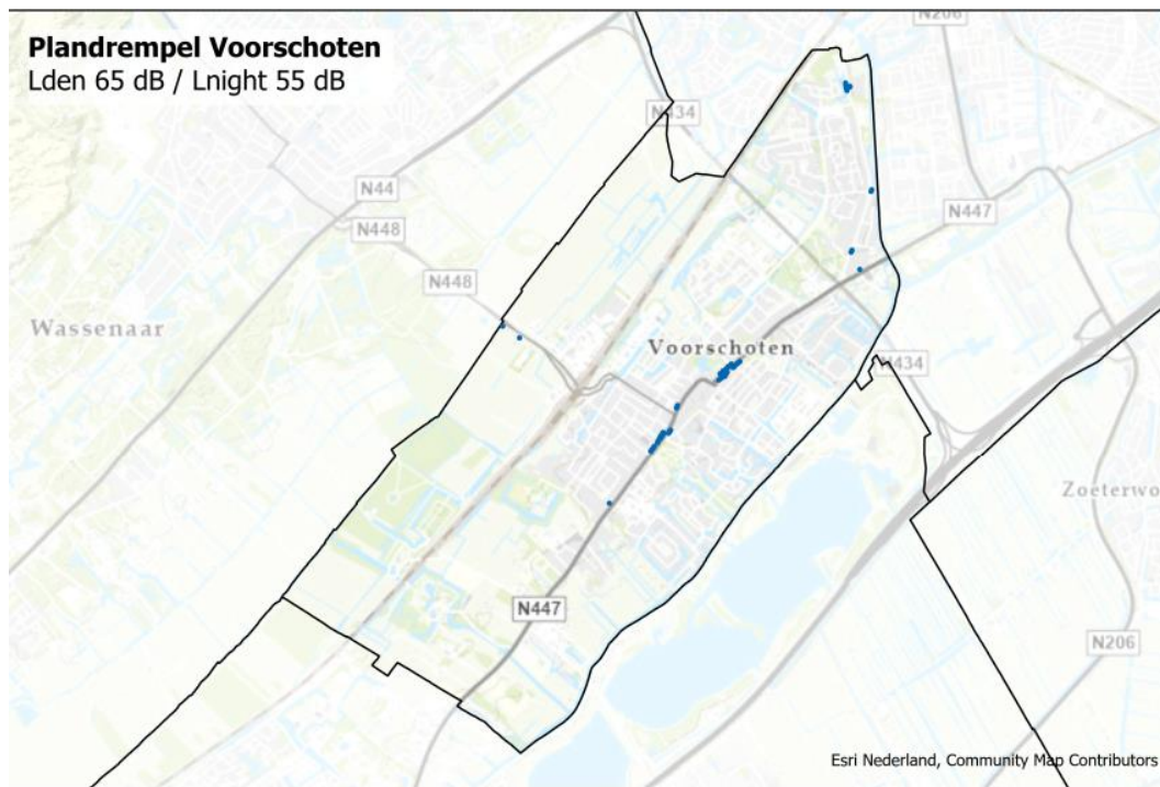
figuur 9: overzicht locaties met overschrijding plandrempel 65 dB L den / 55 dB L night
